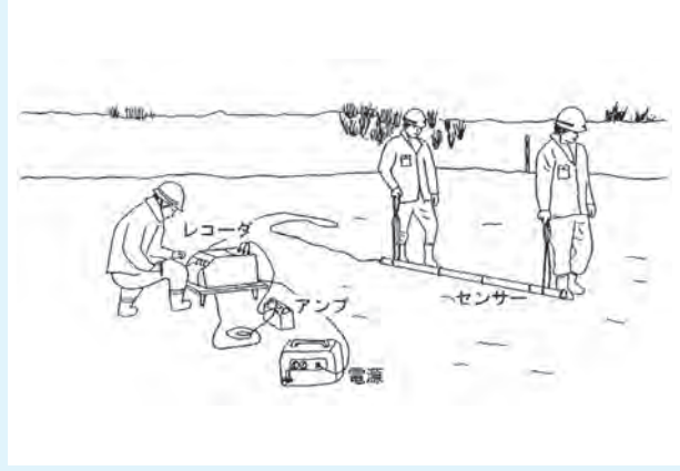
図21 埋没鉄類探査の地上水平探査
