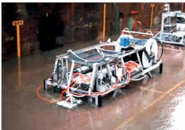
第4図 1999年乾ドック試験（3電極は束ねて海水中に浸けている）
